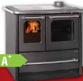
SOVRANA EASY antracite / cappuccino Dimenzije: 964 x 848 x 641 mm. Odprtina kurišča: 217 x 190 mm. Dimenzije kurišča: 220 x 220 x 400 mm. Velikot pečice: 330 x 295 x 415 mm. Teža: 140 kg. Ogrevalna prostornina: 215 m³. Maksimalna moč: 9,2 kW. Nominalna moč: 7,5 kW. Izkoristek: 81 %
