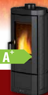
CANDY Dimenzije: 404 x 890 x 397 mm. Teža: 85 kg. Ogrevalna prostornina: 177 m³. Nominalna moč: 6,2 kW. Izkoristek: 85,1 %.
